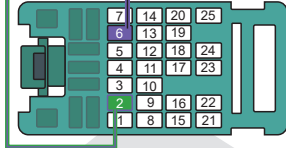
③ Back view 25-Pin Green Connector At BCM Vue de dos Connecteur Vert de 25-Pins Au BCM
