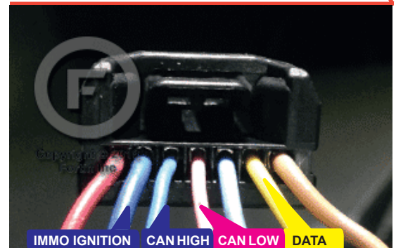
② Immobiliser connector Connecteur d'immobilisateur
