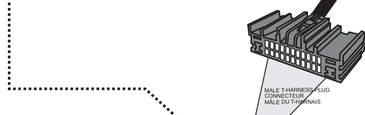
① Gateway module, Behind OBD-II connector - located at dash board driver's side - Back view, 24-pin black connector. Module Passerelle réseau, Derrière le connecteur OBD-II situé dans le tableau de bord, côté conducteur. Vue de dos, connecteur Noir de 24-pins.
