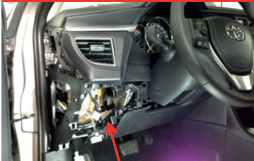
② BCM, connector located beside the fuse cover BCM, connecteur à côté du couvercle à fusibles
