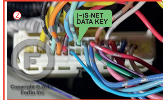
② Passenger Kick Panel. Top of Fuse Box Panneau Latéral côté Passager Sur le dessus de la boîte à Fusibles
