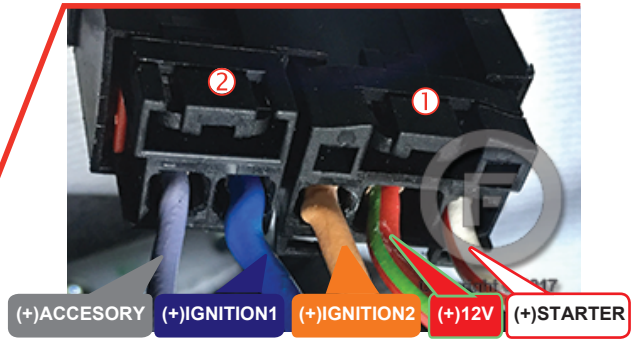
① ② Ignition switch. Commutateur d'ignition.
