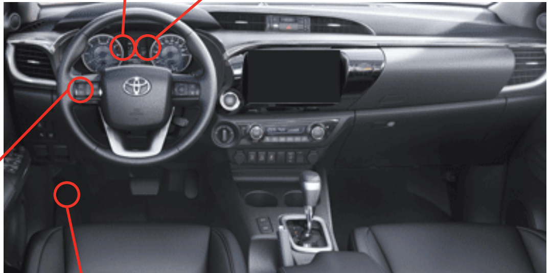
④ Adapter connector Behind the lining at the driver's foot Connecteur d'adaptateur Derrière la doublure au pied du conducteur
