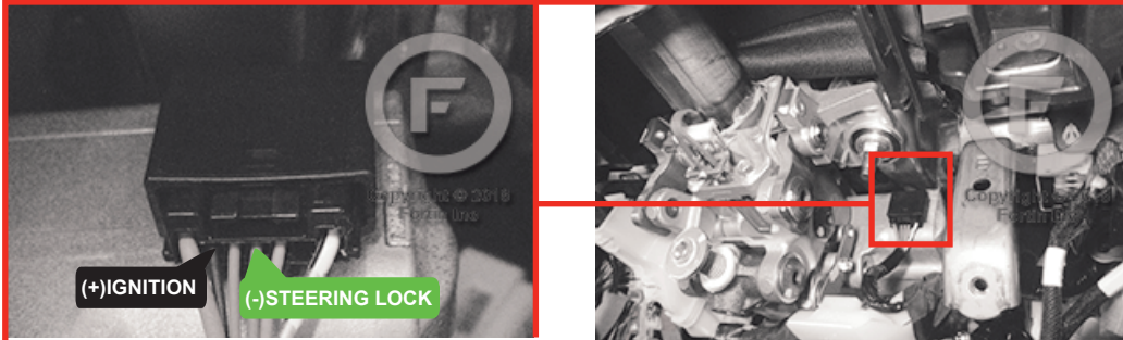
② Steering Lock Connector At steering column Connecteur Steering Lock À la colonne de direction
