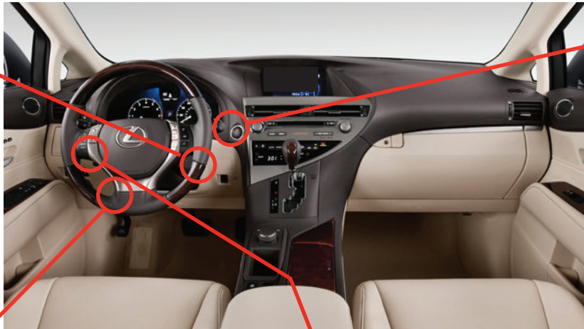
③ MAIN BODY ECU - BELOW DASH FUSE BOX MAIN BODY ECU - SOUS LE TABLEAU DE BORD, SOUS LA BOÎTE À FUSIBLES
