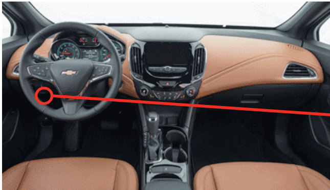
BCM, Above Driver kick panel BCM, Au-dessus du panneau latéral côté conducteur
