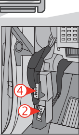
④ Back view Black 48-pin connector in the driver's side kick panel Vue de dos Connecteur Noir de 48 pins Panneau latéral côté conducteur
