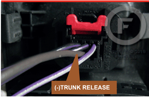
⑦ At trunk switch Au commutateur de la valise
