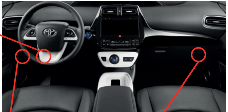
③ Certification ECU behind Glove Box. Top connector. Certification ECU, Derrière le coffre à gant. Connecteur du haut.
