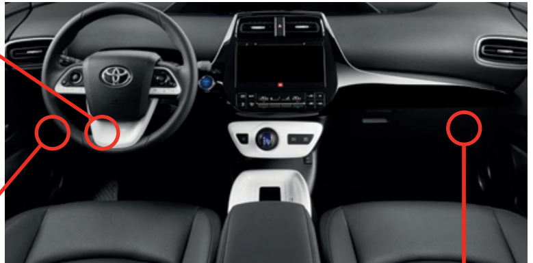
③ Certification ECU behind Glove Box. Top connector. Certification ECU, Derrière le coffre à gants. Connecteur du haut.
