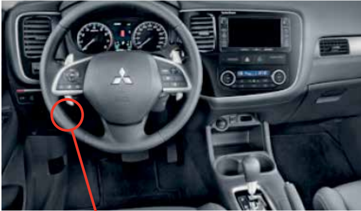
① Fuse box Boîte à fusibles
