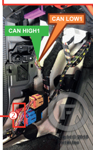
② ⑥ Driver's kick panel harness Harnais provenant de la porte côté conducteur
