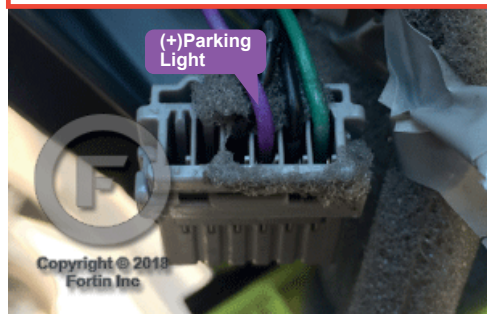
④ At anti-skid switch Commutateur de contrôle dynamique
