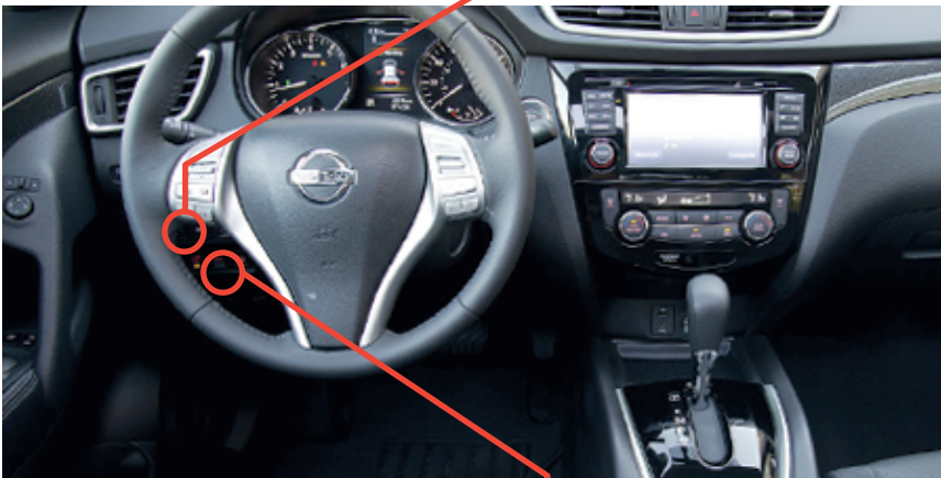
① OBD-II connector Connecteur OBD-II
