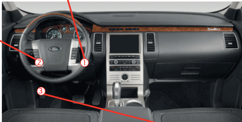
③ BCM Driver kick panel BCM Panneau latérale côté conducteur
