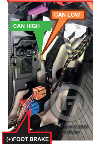
⑥ harness coming from drivers door, located in drivers kick panel. harnais provenant de la porte côté conducteur, situé dans le panneau latéral côté conducteur.
