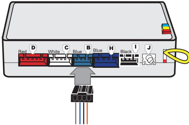
Connectez le REVO au connecteur bleu à 4 broches avec le clip du EVO-ONE utilisant un connecteur à 4 broches avec clip.
