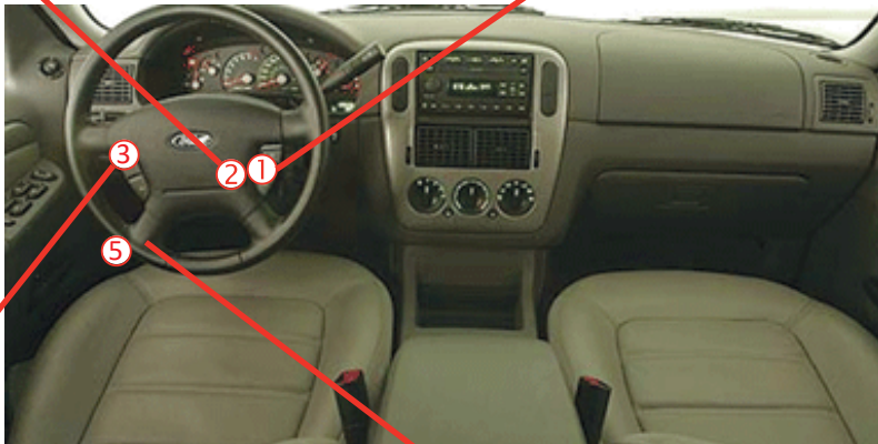
⑤ Harness from driver door Harnais de la portière côté conducteur
