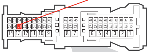
③ Back view White 56-pin Connector Behind Fusebox, driver side dash. Vue de dos Connecteur Blanc de 56 pins Sous la boîte à fusibles, tableau de bord côté conducteur.
