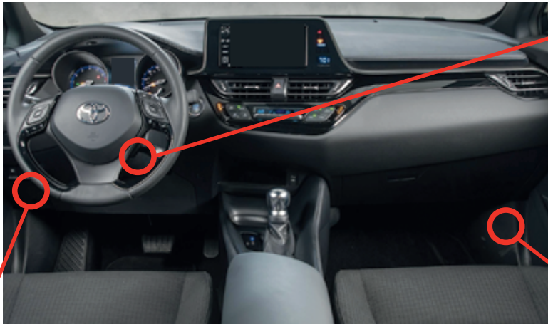
① Steering lock connector Connecteur Steering Lock
