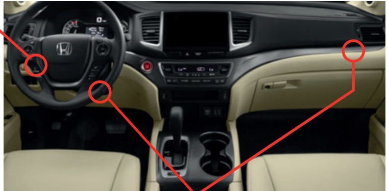
③ At steering lock module under steering column Au module verrouillage de la colonne sous la colonne de direction
