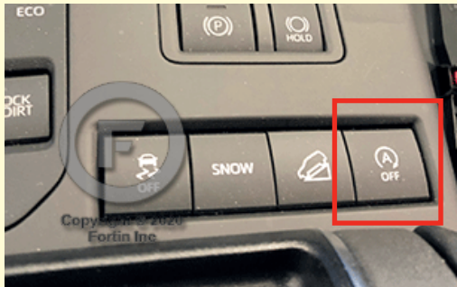
②C With stop and start system (Look for button in center console) Avec système stop et start (Regardez pour bouton à la console centrale)
