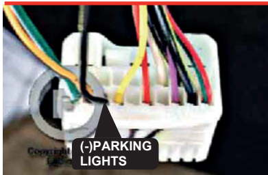
④ At Parking Lights switch Au commutateur des feux de stationnement
