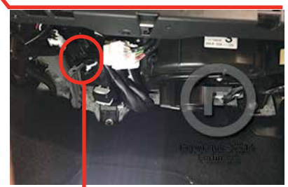
② ECU Behind glove box ECU Derrière le coffre à gants
