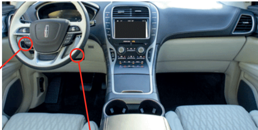
① Gateway module, Behind OBD-II connector Module Passerelle réseau, Derrière le connecteur OBD-II
