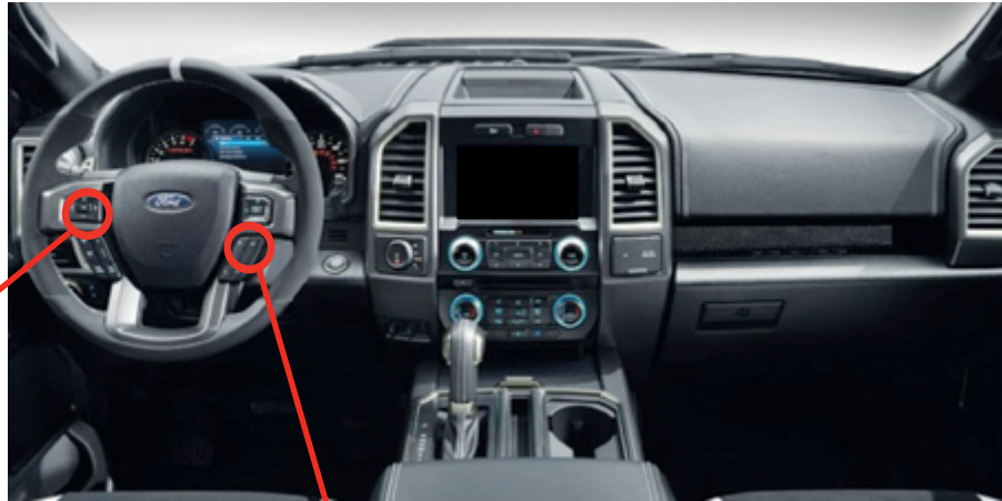
① Gateway module, located at right of steering column. Module Passerelle réseau, situé à droite de la colonne de direction.
