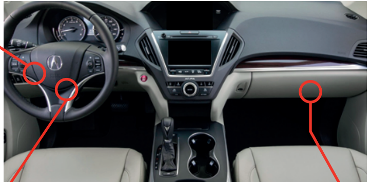
① ② At Smart PCU Module, above glove bx Au module Smart PCU, au-dessus du coffre à gants
