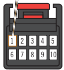
Back View - Black 10-pin Connector - At Parking Lights switch Vue de dos - Connecteur Noir de 10 pins - Au commutateur des lumières de stationnement.
