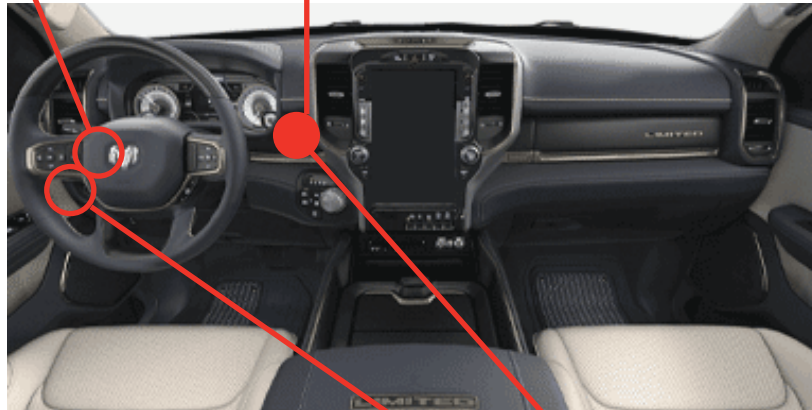
③ Near ignition switch. Connector of electric brake module. Près du commutateur d'ignition. Connecteur du module de frein électrique.
