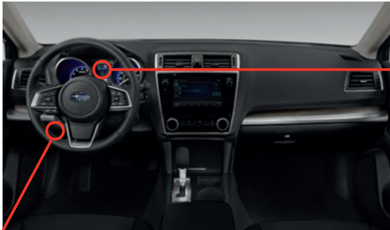
⑤ Keyless access ECU, behind cluster. ECU de téléverrouillage, derrière l'instrumentation.
