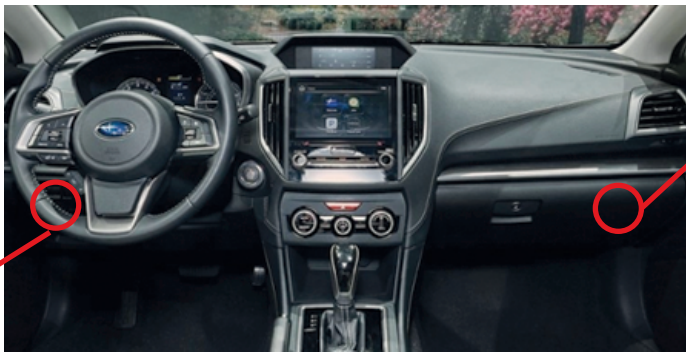
③ Junction connector, behind fuse box Connecteur de jonction, derrière la boîte à fusible
