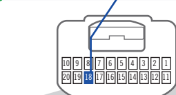
4 Back view White 20-pin connector At Light switch harness Vue de dos Connecteur Blanc de 20 pins Au Harnais des feux de stationnement
