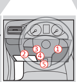
④ Back view - Black 16-pin connector, At Parking light harness, above key barrel. Vue de dos - Connecteur Noir, 16-pins, Au Harnais des feux de stationnement, au dessus du barillet d'ignition.
