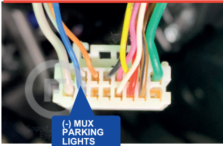
2A Parking lights switch commutateur des feux de stationnement
