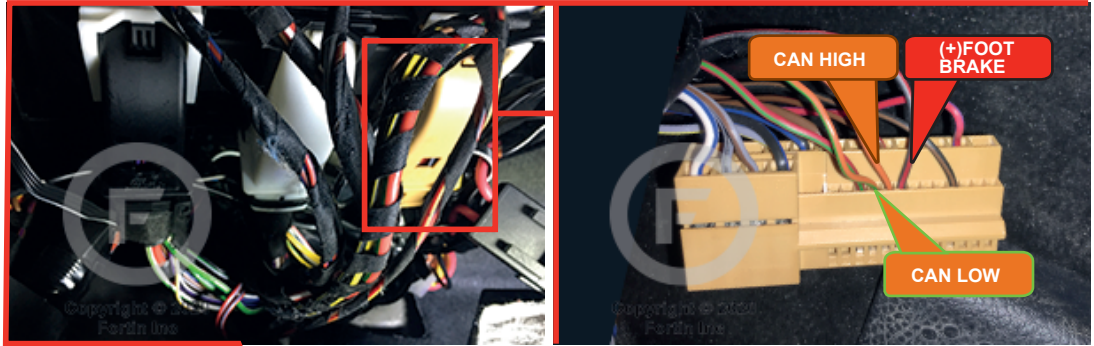
② BCM, Under the dash Driver side BCM, Sous le tableau de bord côté chauffeur
