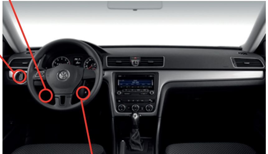
① Key port connector Connecteur du récepteur de la clé
